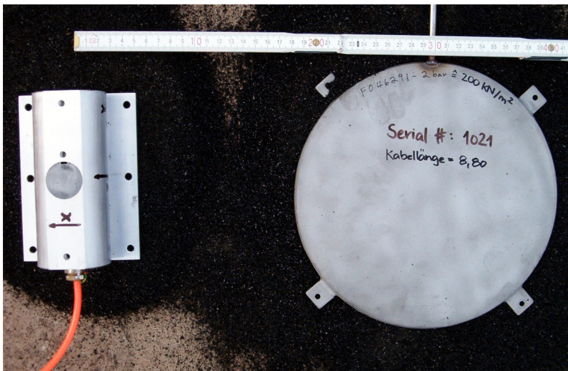
Abb. 6: Messgeber zur Bestimmung der Druckspannungen und der Schwinggeschwindigkeiten unter der Festen Fahrbahn infolge Zugüberfahrt
