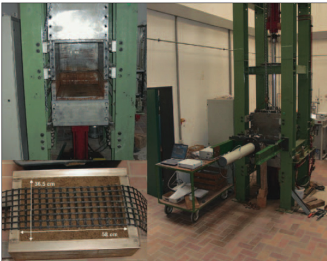
Bild 6 Großrahmenscherversuchsstand – Konfiguration für die Herauszieh- und Überlappungs-Versuche
